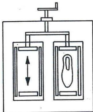
Da der Schuh an der Seite, Spitze und Ferse die gleiche Temperatur aufweist, sind die Heizkörper für Spitze und Ferse über ein Handrad verstellbar (siehe Skizze).
